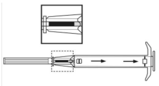
3. Ziehen Sie den Kolben des Applikators **vollständig zurück, bis Sie eine durchgehende Linie im zweiten Fenster sehen.**
